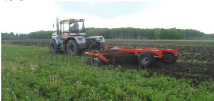
Рис. 5. Обработка почвы дискатором БДМ 4х2 П (с катками) Fig. 5. Soil tillage with a 4x2 P disc harrow (with rollers)
