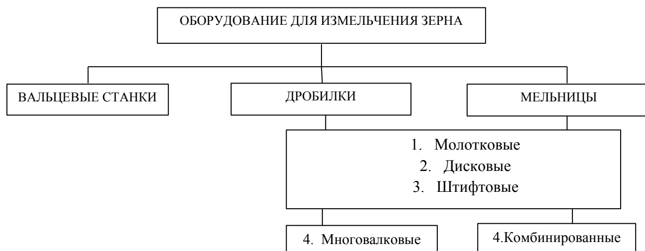
Рисунок 2 – Классификация оборудования для измельчения сырья.
