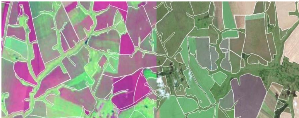
Рисунок 4 – Дешифрирование границ сельскохозяйственных участков и типов землепользования по разновременным снимкам разного разрешения
