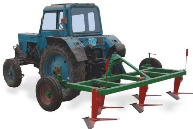
Рисунок 2. Плоскорез КПН-4
