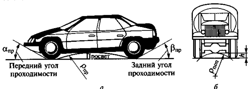
Рис. 8.1. Геометрические показатели проходимости автомобиля: а – легковой автомобиль, вид сбоку; б – грузовой автомобиль, вид спереди
