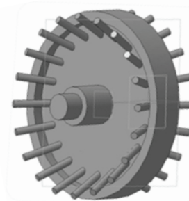
Рис. 3. Каток-гребнеобразователь, оснащенный рабочим органом в виде диска с прутками
