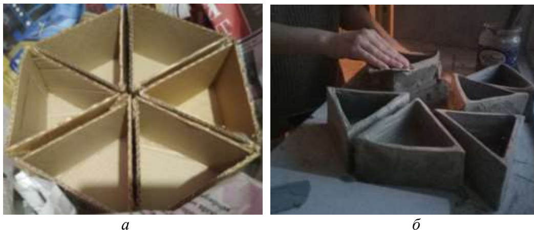
Рис.1. Этапы создания модулей: а – форма для модулей, б – готовые модули
