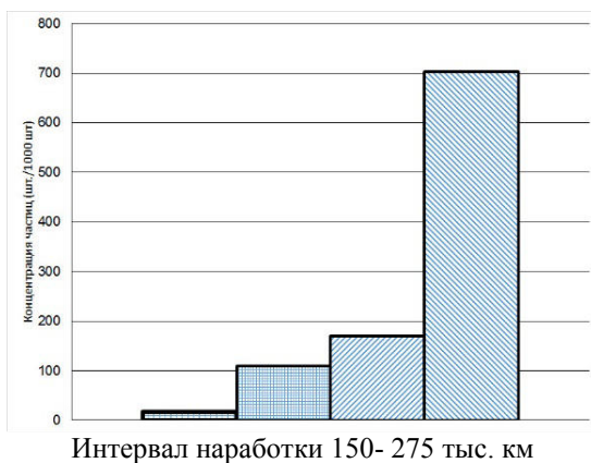
Рисунок 9 – Гистограмма распределения концентрации частиц износа в трибомеханической системе «кольцо подшипника-корпус»
