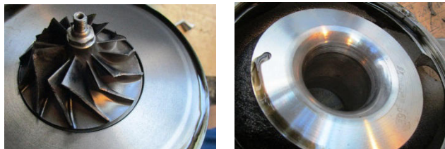
Рисунок 2 – Равномерные повреждения лопаток по окружности колеса от взаимодействия с диффузором
