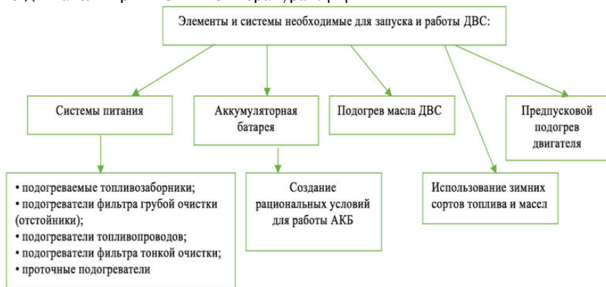
Рисунок 1 – Элементы и системы необходимые для запуска ДВС в зимних условиях крайнего севера
