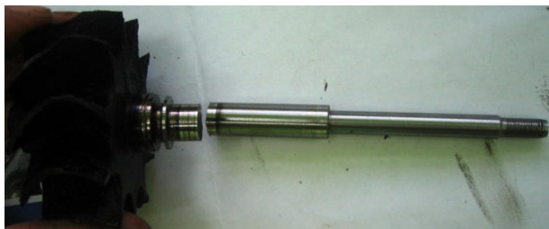
Рисунок 5 – Разрушение вала турбокомпрессора
