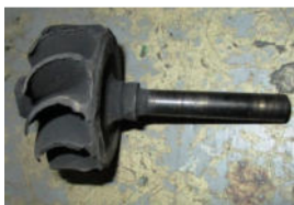
Рисунок 3 – Шейка вала под радиальный подшипник имеет эксплуатационные отложения в виде нагара
