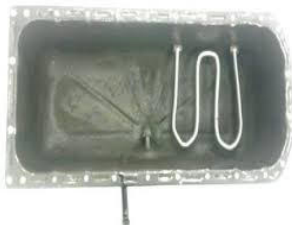
Рисунок 5 – Тэн в поддоне картера ДВС
