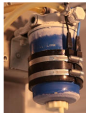
Рисунок 3 – Подогреватель на фильтре тонкой очистки
