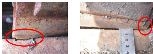
Рисунок 2 – Взаимодействие деформированного ножа с противорежущим брусом
