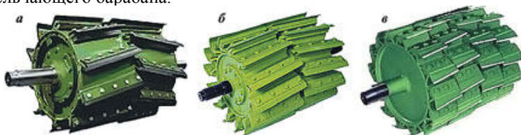
Рисунок 1 – Измельчающие барабаны кормоуборочных комбайнов: а – фирма Krone; б – фирма Claas; в – барабан Dura-Drum фирмы John-Deere
