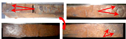
Рисунок 3 – Наличие следов фиксации бруса в четырех положениях
