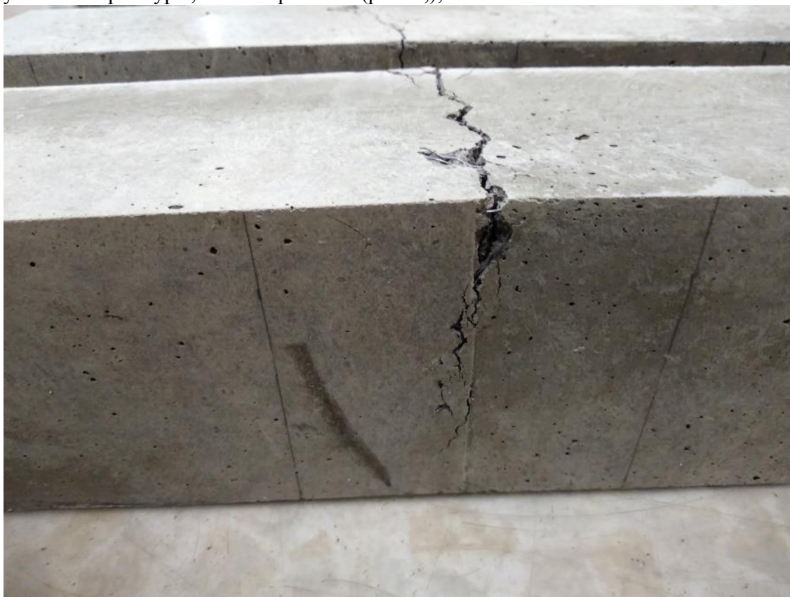
Рисунок 1. Образец фибробетона, после испытания прочности на растяжение при изгибе.
