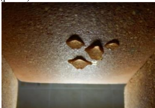
Рисунок 2 - Результаты определения водонепроницаемости на образцах с водопоглощением более 10 %.
