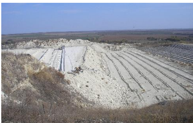
Рисунок 3 - Разработка карбонатных пород для получения пиленных стеновых камней.
