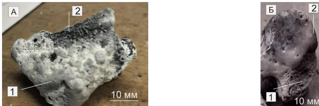
Рис.4. Фрагменты образцов А и Б после высокотемпературного воздействия плазменной струей в атмосфере азота. Образец А: 1 – участок образца с белым налетом; 2 – пористая часть образца. Образец Б: 1 – пористая часть образца; 2 – стекловидная поверхность образца.
