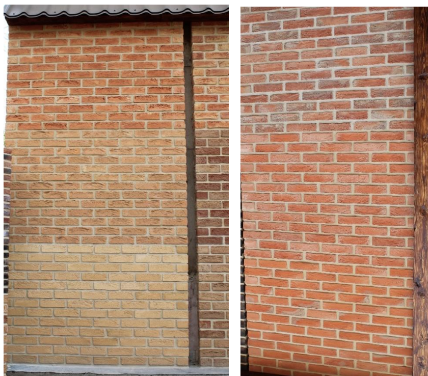
Рисунок 2 - Лицевой керамический кирпич на основе среднеглинистых и глинистых опок, полученный по технологии мягкого формования.
