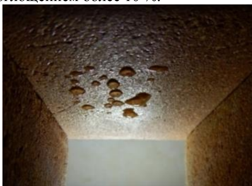
Рисунок 3 - Результаты определения водонепроницаемости на образцах с водопоглощением 6-10 %.
