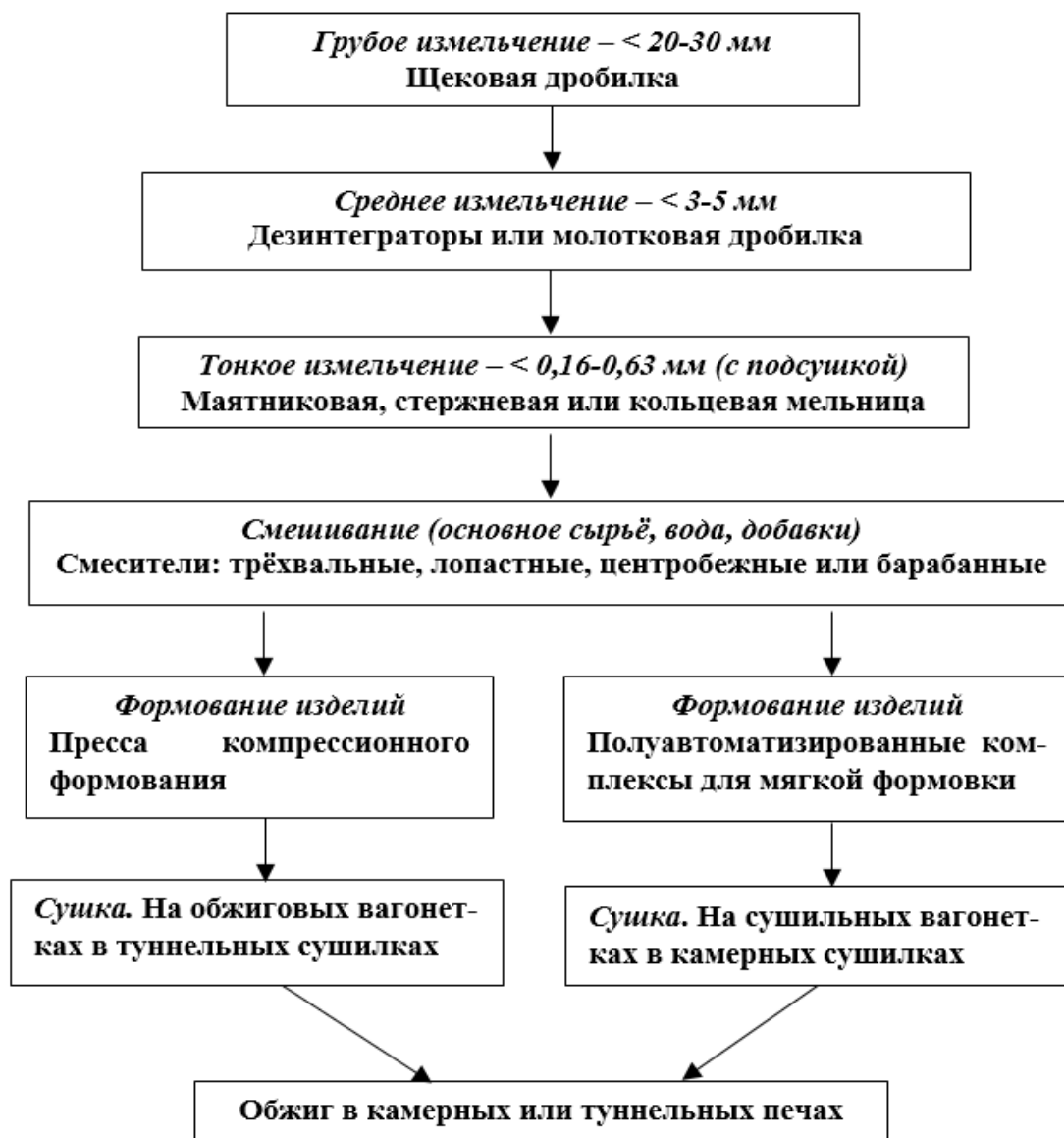
Рисунок 5 - Вариативная технологическая схема производства дорожного клинкерного кирпича на основе аргиллитов или аргиллитоподобных глин
