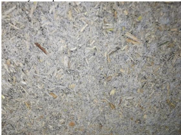
Рисунок 4 - Фактура полученного образца костробетона
