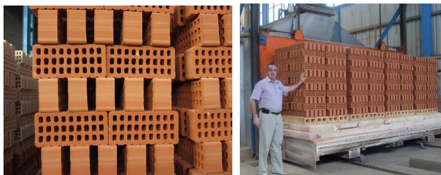
Рисунок 4 - Керамический кирпич, полученный способом компрессионного формования на основе глинистых видов опок.
