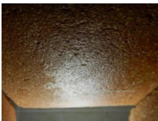
Рисунок 4 - Результаты определения водонепроницаемости на образцах с водопоглощением 3-6 %.
