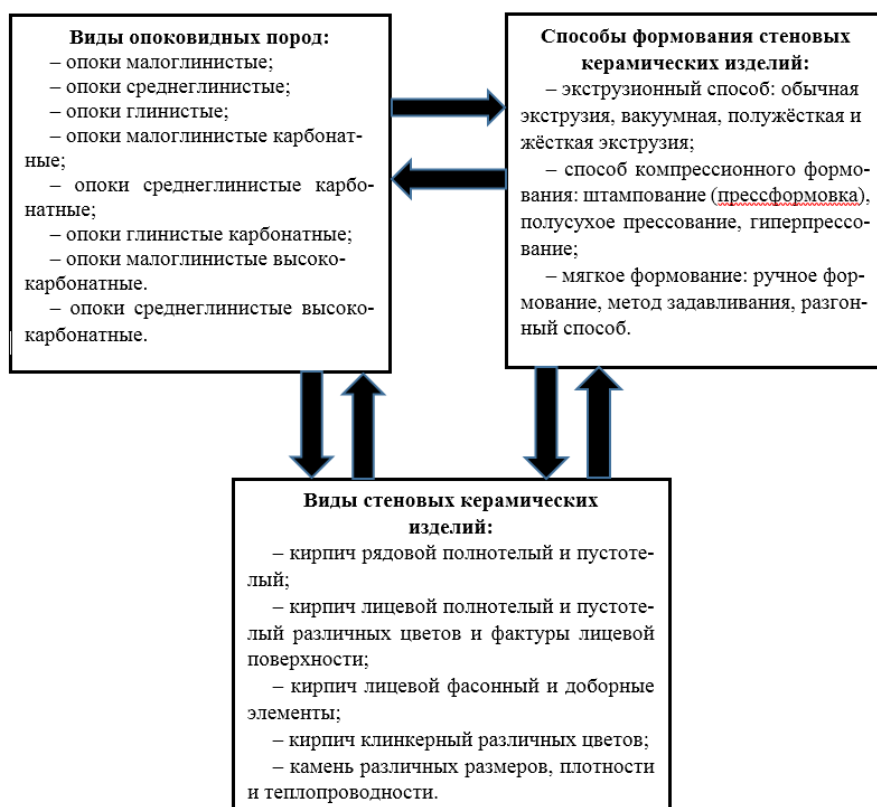
Рисунок 1- Блок-схема взаимосвязи видов опоквидных пород, способов формования и видов стеновых керамических изделий.
