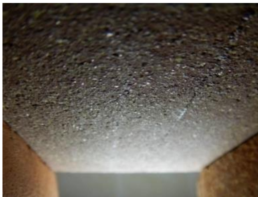
Рисунок 5 - Результаты определения водонепроницаемости на образцах с водопоглощением менее 3 %.
