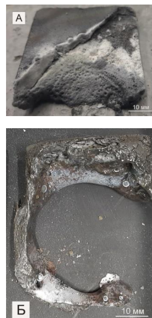
Рис.3. Образцы А и Б после воздействия низкотемпературной плазмы
