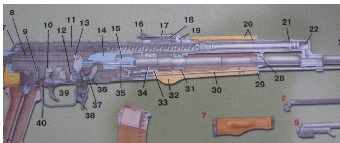
Разрез АК для примера последовательности разборки автомата
