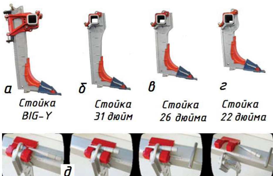
Рисунок 1 –Стойки разных рабочих органов, оснащенные быстросъёмным устройством крепления на брус рамы машины, с срезным штифтом, конструкции Йоманса [6]: а – стойка размер BIG-Y; б – стойка размер 31 дюйм; в – стойка размер 26 дюймов; г – стойка размер 22 дюйма; поэтапная (покадровая) схема извлечения срезного штифта для снятия стойки с бруса рамы машины.
