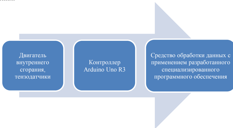
Рисунок 3. Схема работы предлагаемого устройства для приема, преобразования и анализа диагностических данных
