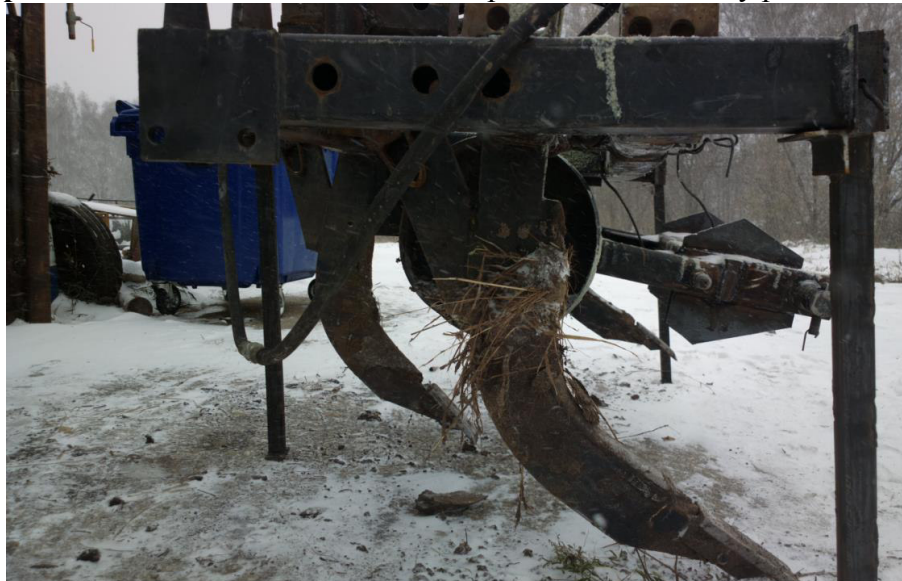
Рисунок – 4 Свободные колебания рабочих органов глубокорыхлителя в почве с частотой 10,2 Гц позволяют оставлять рабочий орган без почвенных наростов, за исключением вертикальных участков на которых остаётся солома смешенная с почвой.
