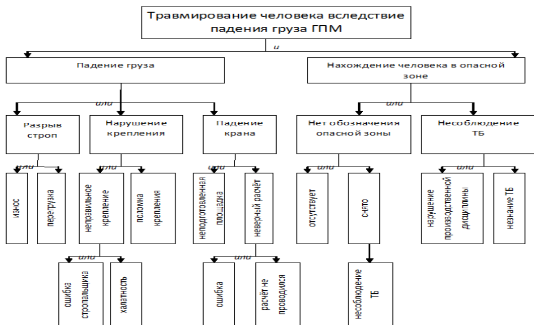
Рисунок 1 - Дерево причин травмирования человека вследствие падения груза ГПМ
