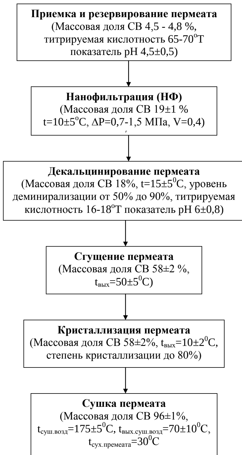
Рисунок 1 - Принципиальная технологическая схема получения сухого деминерализованного пермеата.
