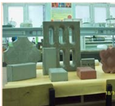
Рис. 1 – Образцы строительных изделий с использованием ЗШО
