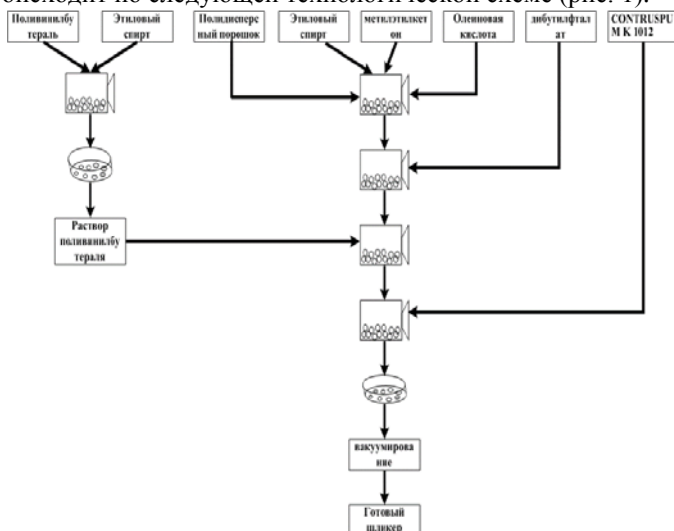
Рисунок 1 Технологическая схема приготовления шликера
