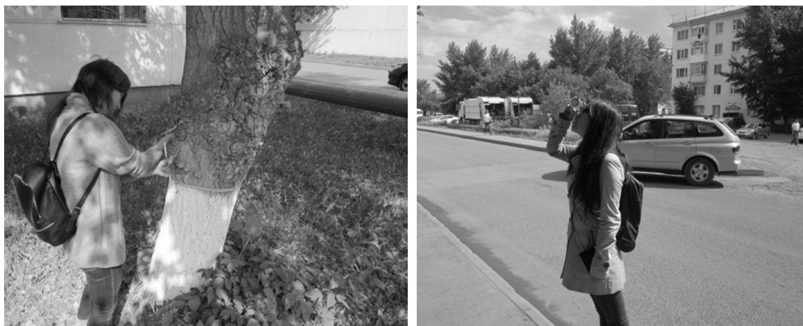
Рисунок 1 – Определение диаметра ствола и высоты дерева с помощью высотомера SUUNTO
