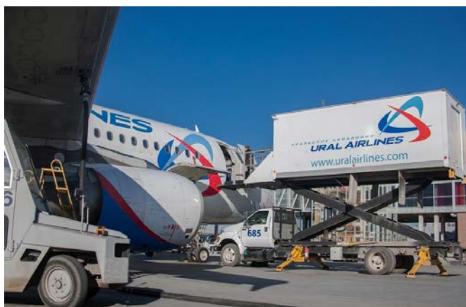
Рис. 5. Автолифт для доставки бортового питания на борт воздушного судна
