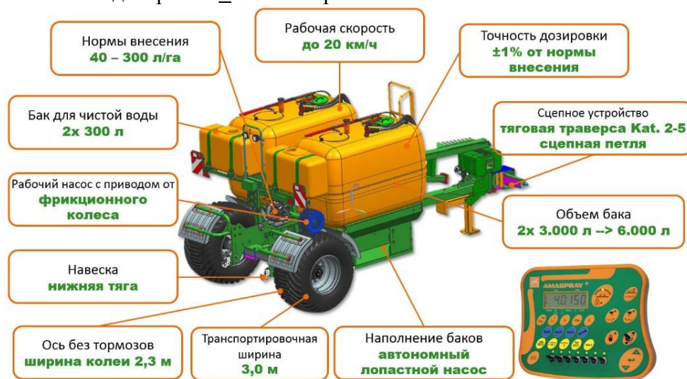
Рисунок 4 – Агрегат FDC 6000 - Для сеялок и почвообрабатывающих машин (Cenius) при одновременном с посевом и обработкой почвы внесении КАС
