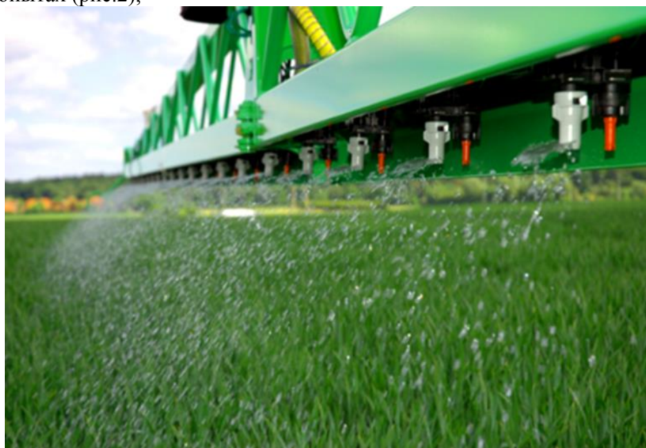
Рисунок 1 – Опрыскивание посевов жидкими удобрениями крупнокапельными форсунками
