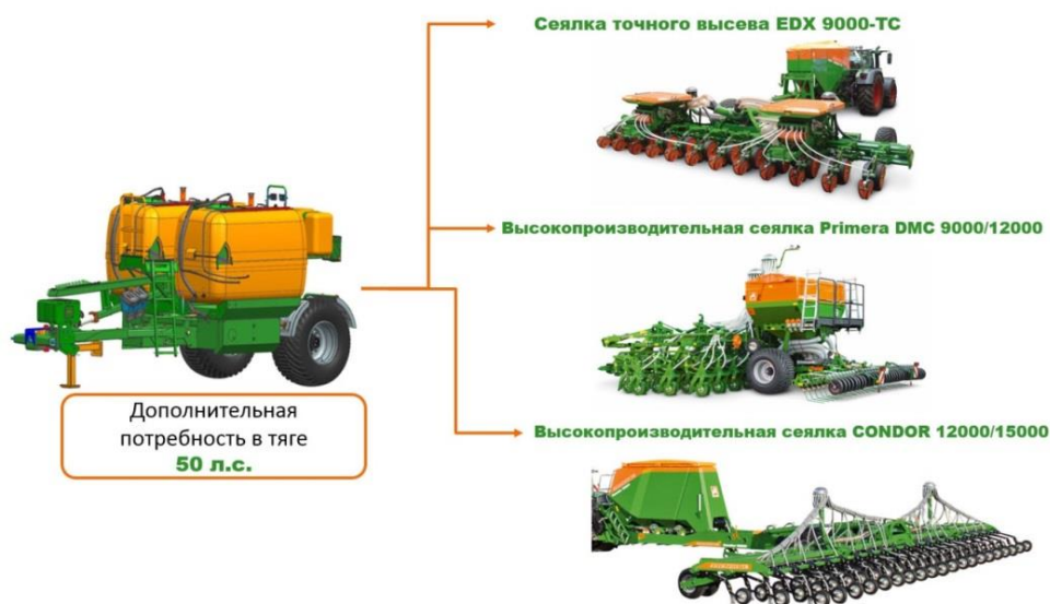
Рисунок 5 – Варианты использования агрегата FDC 6000 с зерновыми и пропашными сеялками компании «AMAZONEN-Werke»
