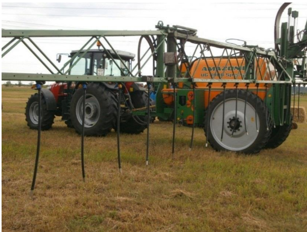
Рисунок 2 – Подкормка опрыскивателем с удлинительными шлангами
