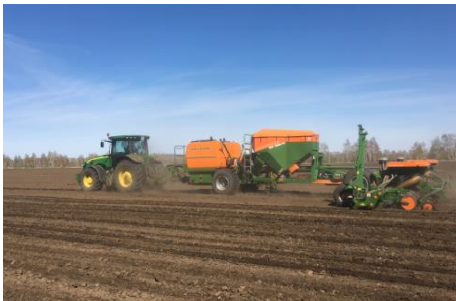
Рисунок 6 – Внесение КАС при посеве подсолнечника агрегатом FDC и сеялкой EDX в АО «Земледелец» Балашовского района Саратовской области
