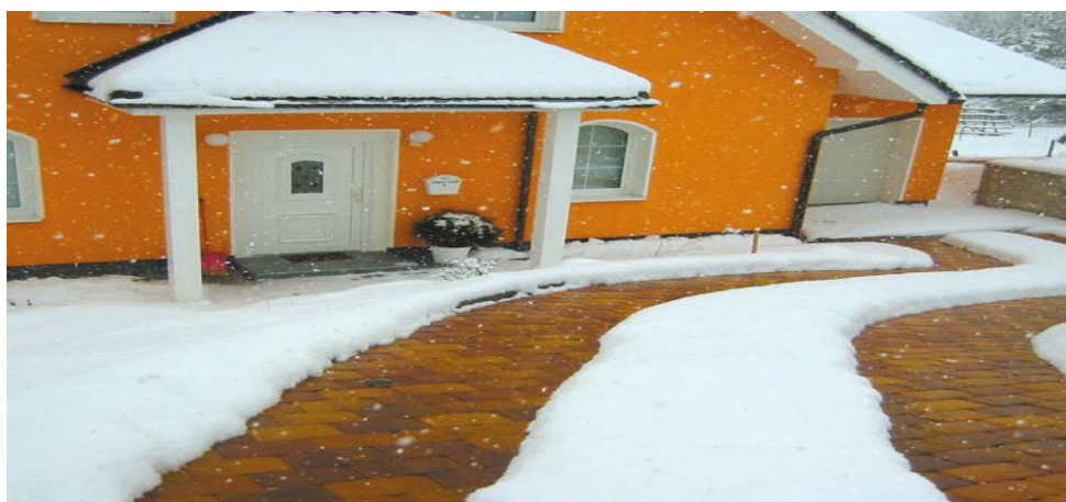
Рис. 2. Пример использования систем подогрева садовых дорожек [3]
